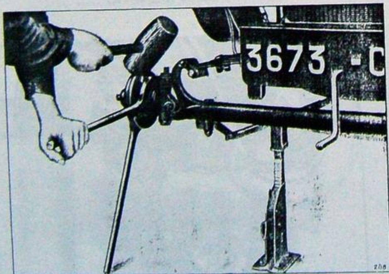
Fig. 24. — Dévissage de l'écrou du moyeu.
