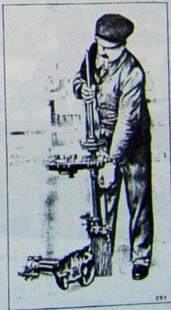
Fig. 29. — Désassemblage du carter du pont. 2 e opération.
