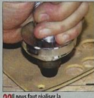
22 Il nous faut réaliser la rondelle caoutchouc d'étanchéité à l'emporte-pièce.
