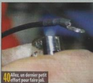
37 Equiper cette extrémité d'une gaine thermorétractable.
