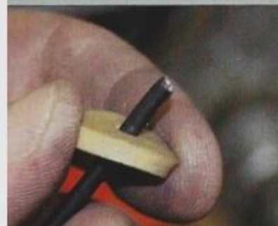
22 Il nous faut réaliser la rondelle caoutchouc d'étanchéité à l'emporte-pièce.
