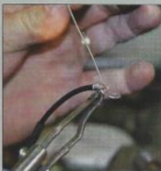
36 Couper le fil de connexion à la bonne longueur. Il faut savoir que plus le fil est court, plus on limite ses effets "résistifs".
