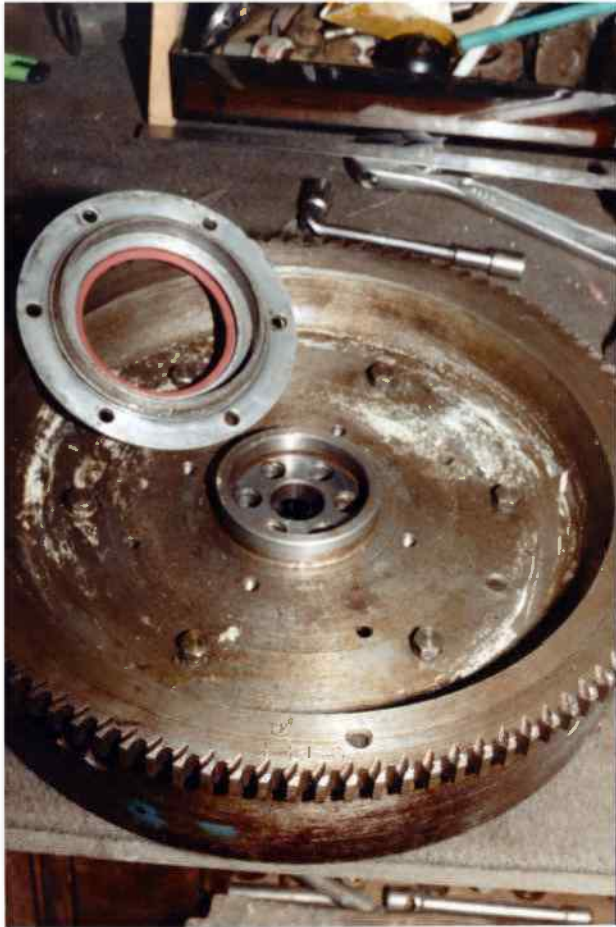
Volant moteur et son épaulement ou 'manchon' à usiner au tour. Assemblage 'gras/libre'
