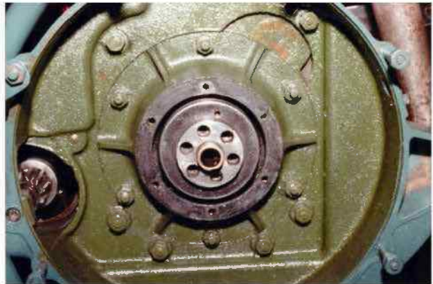
Gros plan sur palier AR, bouchon de palier déposé
