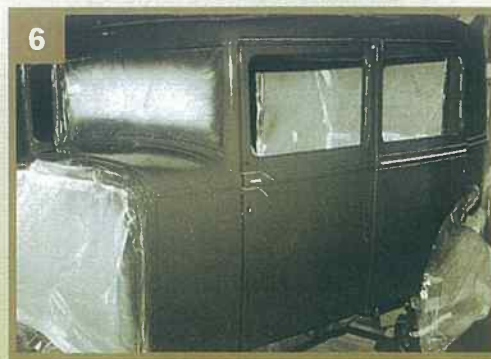
Quelques bâches en plastique ont suffi à improviser une cabine de peinture pour les éléments de tôlerie, comme ici le capot et la malle passés en apprêt.
